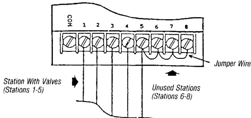
**CONTROLLER USING TERMINAL STRIP**
